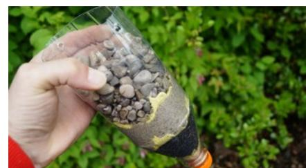
7.) Es folgt eine Schicht Kieselsteine. Achte darauf, dass die Kohle-, Sand- und Kieselschichten in etwa das gleiche Volumen haben.
